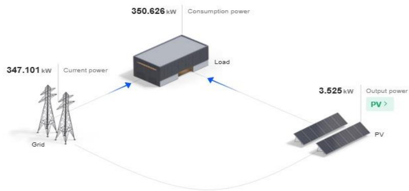
Gambar 8. Aliran Daya jika Zero Export tidak berjalan pada Fusion Solar Sumber: Data olahan
