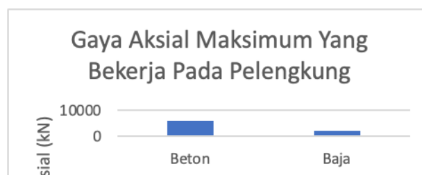
Gambar 1 Gaya Aksial Maksimum Yang Bekerja Pada Pelengkung
