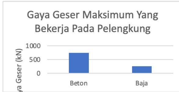
Gambar 2 Gaya Geser Maksimum Yang Bekerja Pada Pelengkung
